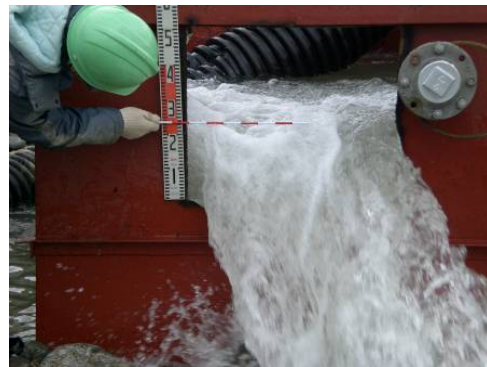
排水量の三角堰による測定状況
