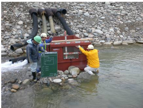
排水量の三角堰による測定状況
