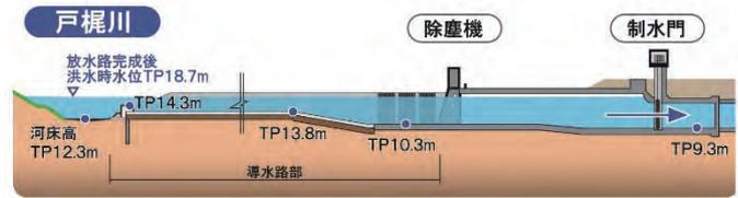
図-4 新日下川放水路呑口側縦断面図
