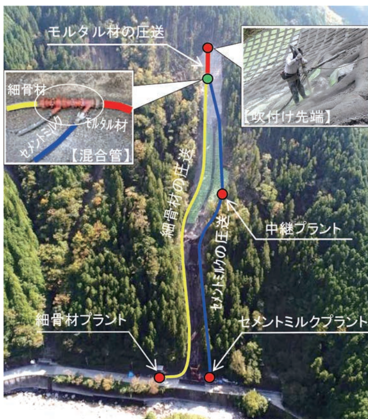
【セパレートショット工法説明図】
