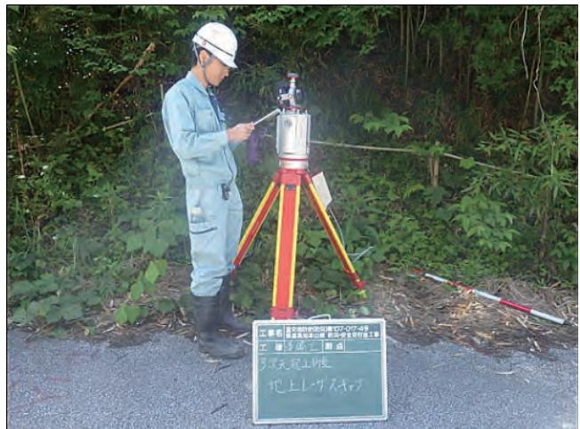
図3 レーザースキャナー測量
