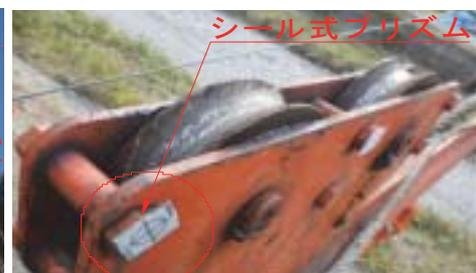
2 (課題) ケーブルクレーンのワイヤー摩耗により劣化交換の判断も重要であるが、何トン輸送したら危険という具体的なデータがなく、またワイヤーの長さやウインチの操作方法などでも劣化の差が出てくる。この為ワイヤーを安全範囲内かつ、経済面及び資源の有効活用の点から安全側で適切な損耗率での交換時期の見極めをどのように判断するか課題となった。
