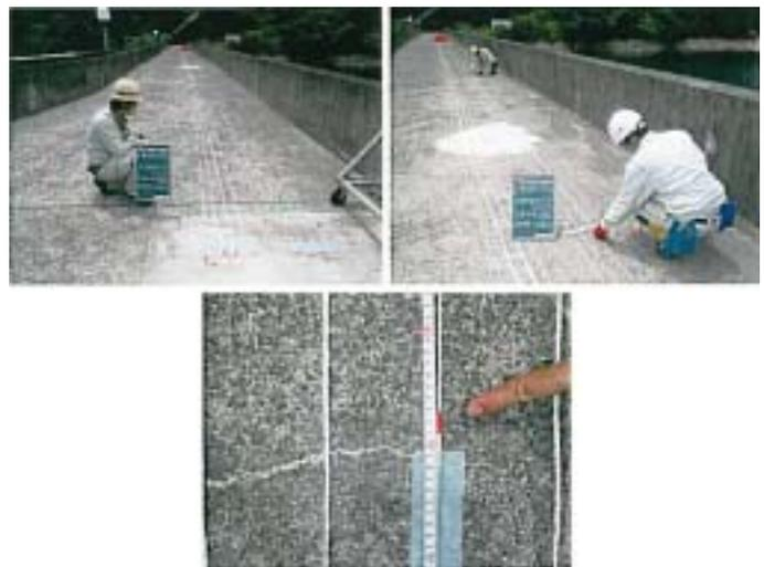
図-4 取付紐の計測状況
