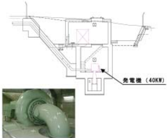
発電機 (横軸フランシス水車) の事例写真
