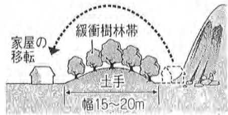
緩衝樹林帯を使った急傾斜地対策
